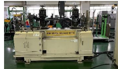
RR CTBA Fatigue Test
