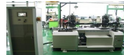
RR CTBA Fatigue Test
