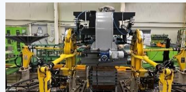
&lt;Dynamic Load Fatigue Test&gt;
