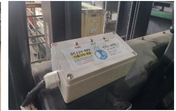
지게차 안전 센서 설치
