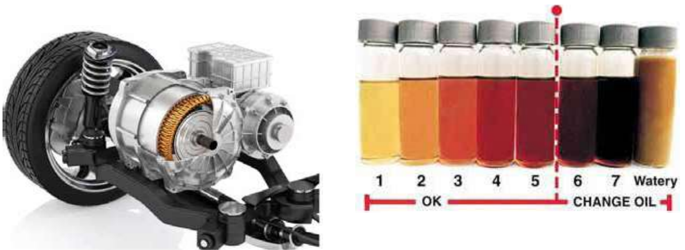
▲ 감속기 구조 및 오일 산화에 따른 색상변화
